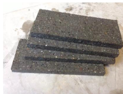
(e) cut specimens 70×30×5 mm
